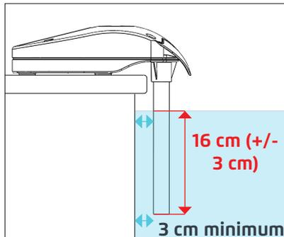
Si la sonde est trop immergée ou ne l'est pas assez (voire pas du tout), votre système d'alarme ne pourra pas fonctionner correctement. Veillez à respecter la profondeur d'immersion recommandée.
